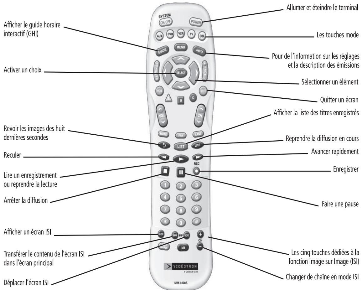
**Les télécommandes requièrent deux piles alcalines AA** que vous insérez dans le compartiment arrière, selon le diagramme dessiné à l'intérieur. Remplacez-les lorsque le témoin lumineux faiblit ou ne s'allume plus.
